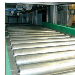
Fördertechnik und Verkettung Verkettung ganzer Fertigungslinien z.B. Rollgänge, Kunststoffplattenbänder, Kettenförderer und Riemenbandförderer
