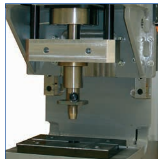
Servo-Pressen Servoelektrische Montagepressen zum kraft- und/oder formschlüssigen Fügen
