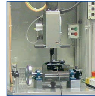
Montage- und Fügesysteme mit Kraft- und Drehmomentmessung inkl. parametrierbarer Abschaltung
